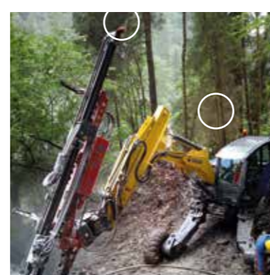
Einsatzbeispiele RS193rM als Fixpunkt auf unterschiedlichen Oberflächen und zum exakten Ausrichten der Bohrlafette.
